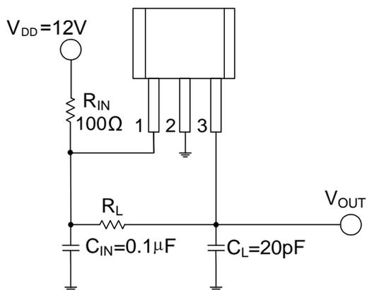
注:  $R_{IN}$ 、 $C_{IN}$ 用于稳定外接的电源电压;  $R_L$ 是集电极开路输出所必要的上拉电阻, 取值范围在 $820\Omega \sim 100k\Omega$ , 取决于后端输入所要求的电流能力;  $C_L$ 用于滤除输出噪声, 这个电容会影响输出波形的上升沿时间。
