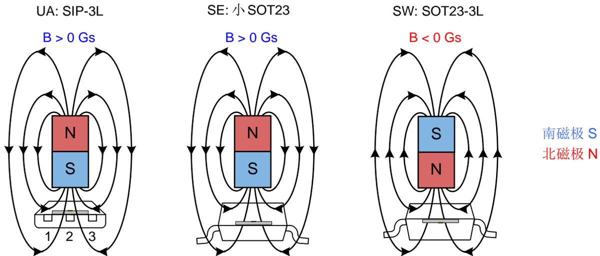
图 2, 磁场感应方向的定义
