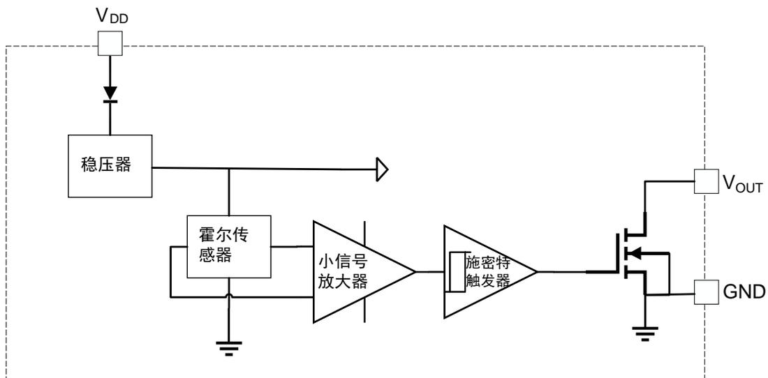
图 1, GH1881 内部结构框图
